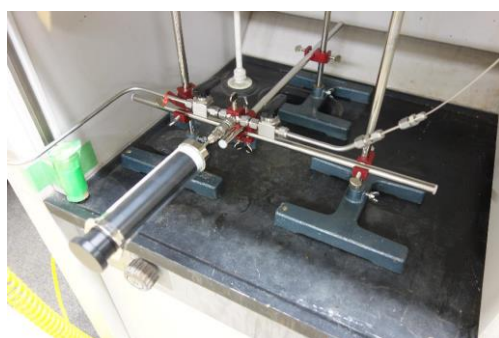
図 4-14 ASTM E659 試験装置 (左: プランジャ系, 右: 銅箔で包んだフラスコ).
