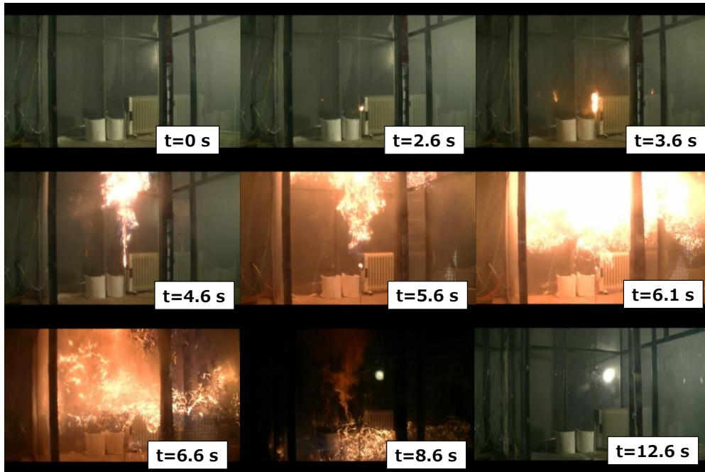
図 3-62 燃焼容器内での冷媒の着火および火炎伝播の様子 t : 通電からの経過時間 冷媒: R1234ze(E), 換気なし, 漏洩量: UFL 相当 (5.7 kg)
