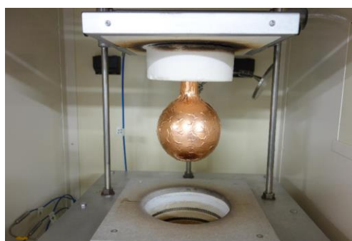
図 4-14 ASTM E659 試験装置 (左: プランジャ系, 右: 銅箔で包んだフラスコ).
