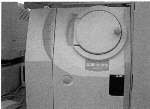
図4 GC/MS 質量分析装置
