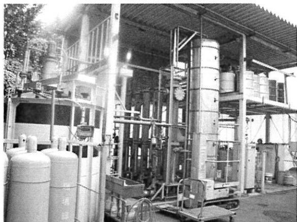
図9 触媒法方式フロン破壊装置
