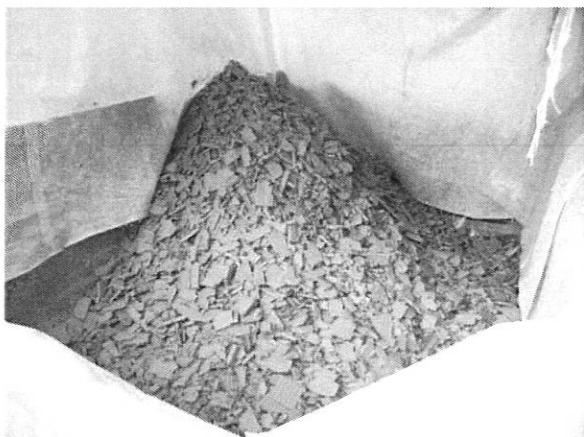
図8 フロン破壊装置から出た残渣（固体）
