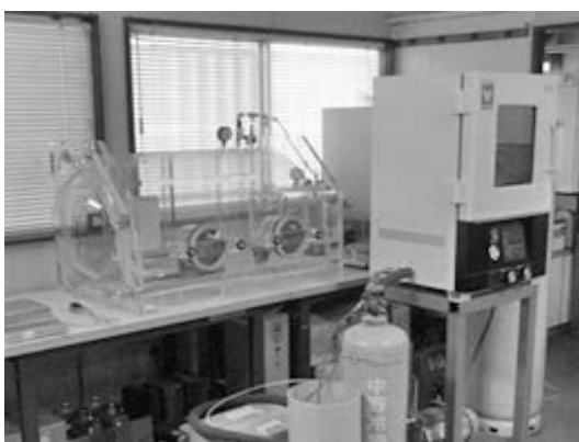
図11 冷媒分析装置
