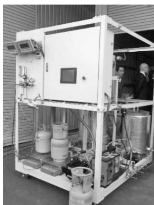
図9 混合冷媒再生処理システム
