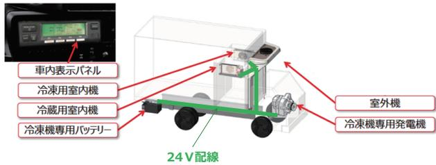
図6 メンテナンスしやすい低電圧配線を採用した搭載機器
