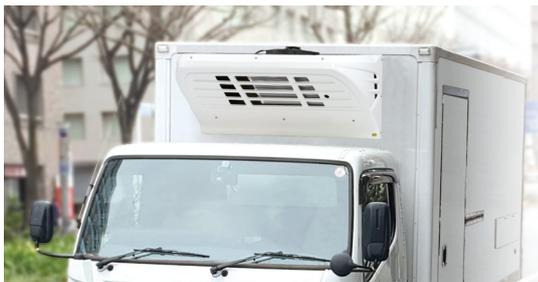
図1 トラックに装着された輸送用冷凍ユニット
