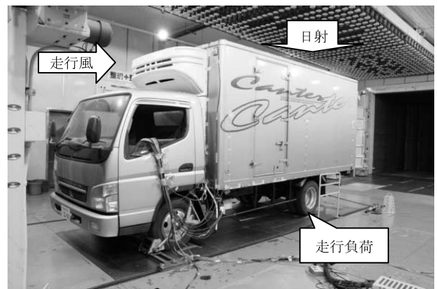
図4 実車燃費試験状況
